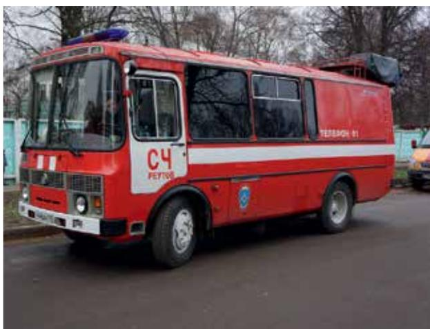
**Рис. 2.17.** Пожарный автомобиль дымоудаления АД-90-22
