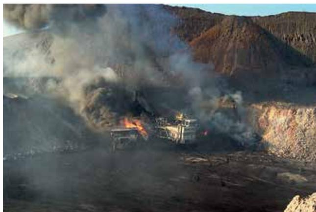
**Рис. 4.7.** Пример горения борта породно-угольного отвала
