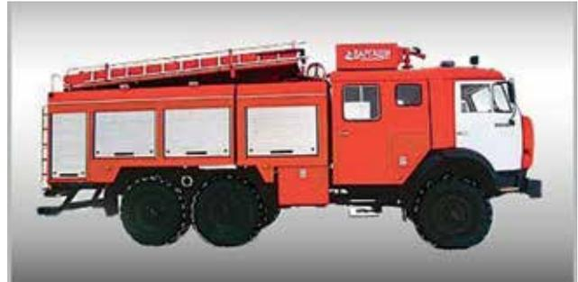
**Рис. 2.12.** Автомобиль насосно-рукавный ПАБР-2,0-20/200 (КАМАЗ-43118)
