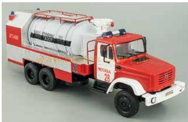
**Рис. 2.16.** Пожарный автомобиль газового тушения АГТ-4000
