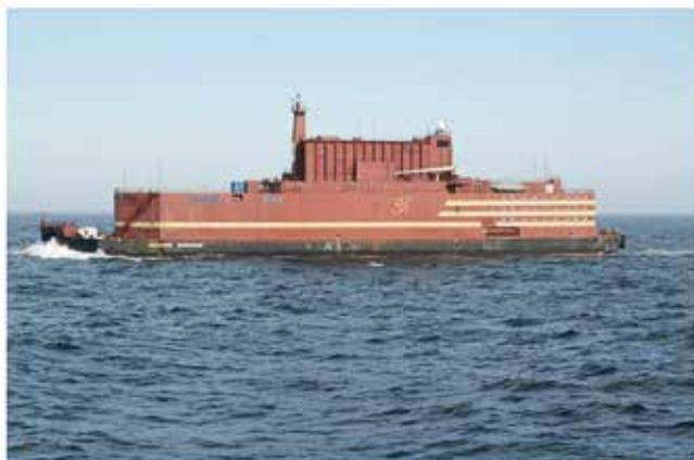
**Рис. 5.9.** Плавающий атомный энергетический блок «Академик Ломоносов»
