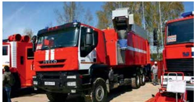
**Рис. 2.14.** Пожарный насосно-рукавный комплекс «Шквал»
