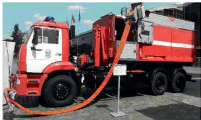
**Рис. 2.15.** Пожарный насосно-рукавный комплекс «Поток»
