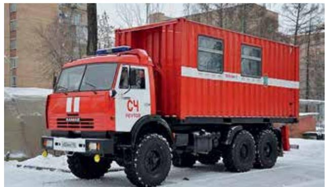
**Рис. 2.13.** Автомобиль пожарно-спасательного контейнерного типа АПСК (43118)
