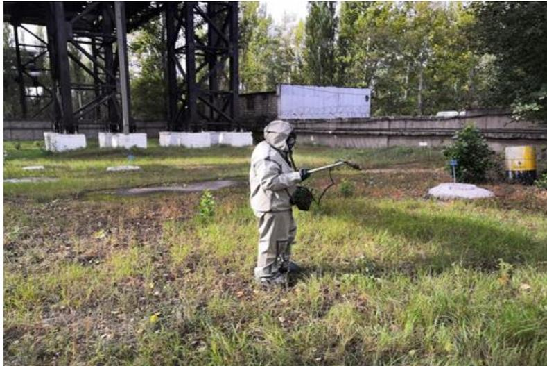
**Рис. 6.43.** Разведчик-дозиметрист поста РХН Липецкой ТЭЦ-2 проводит измерение уровня радиации на территории станции в ходе штабной тренировки по организации защиты работающего персонала при аварии на объекте атомной энергетики
