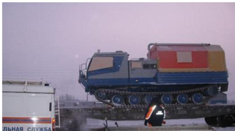
Рис. 3.46. Гусеничный плавающий транспортер ТМ 140-СБ-02
